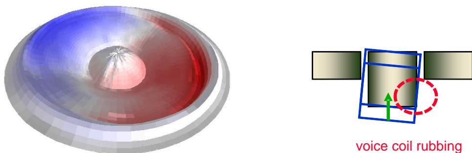
圖 13: 搖擺模態(左)以及音圈摩擦(右)
